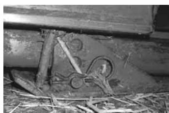
写真3 ストーンガードで高さの調整
