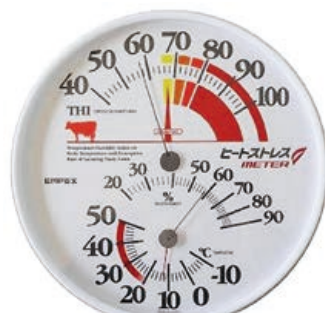
写真1 ヒートストレスメーター THIが一目で分かり、乳牛のストレス度合いを把握しやすい
