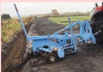
写真1 ①明きょと②カットソイラーの施工
