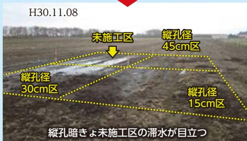
写真3 試験区の滞水状況の推移
