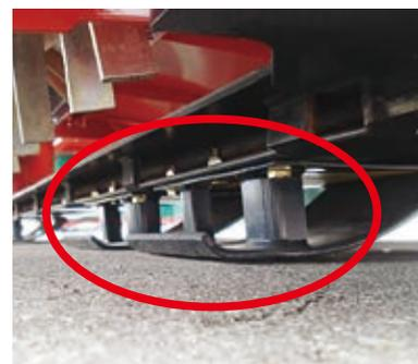
写真1 ハイスキッドプレートを装着したモアコン
