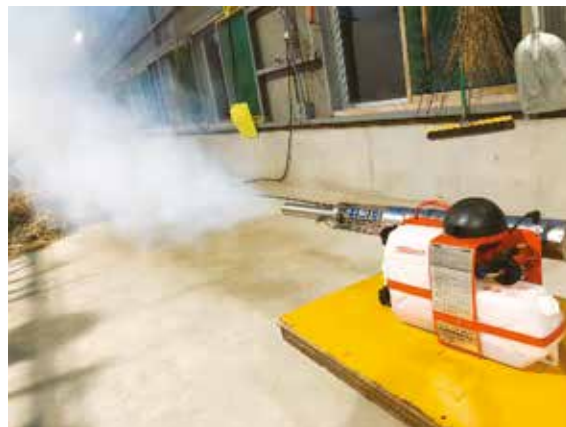
写真1 可搬式噴霧機による煙霧消毒
